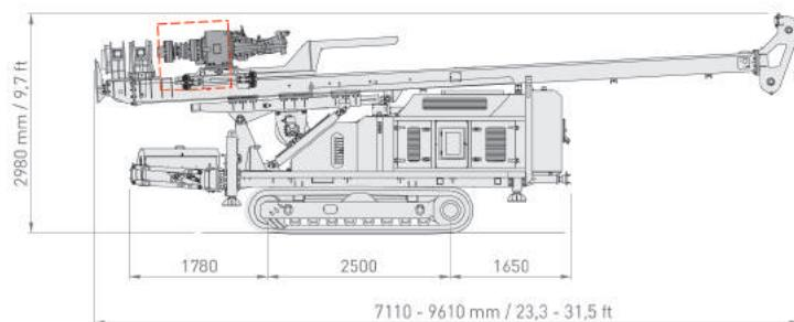
Movimenti Mast (mm) - Mast Movements (mm) - Cinématique du Bras (mm) - Volle Gelenkmöglichkeit (mm)
